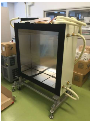
冷却パネル設置後
