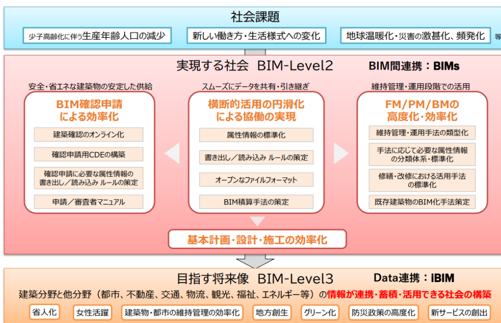
図3.10 建築 BIM 推進会議で示されている将来像と工程表 -2 (増補版)
